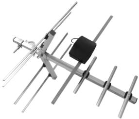
Pasanglah kotak penerima frekuensi pada batang penopang antenna dengan sekrup warna hitam. Perhatikan ada 2 lubang pada atas penopang dan 1 lubang dibawah penopang. Letakkan kotak penerima frekuensi pada 2 lubang.
